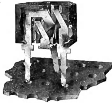
Opengewerkt model van een „lock-fit”-transistor
